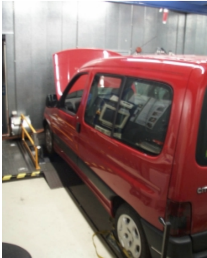
Abb. 3-6: Prototyp auf dem dynamischen Rollenprüfstand
