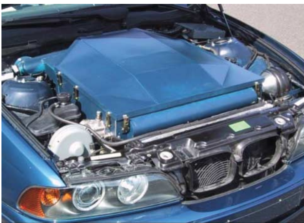
Bild 3: Kapsel mit Schnellverschlüssen Figure 3: Encapsulation with quick fasteners
