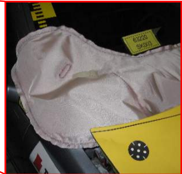
Scharnierbereich mit FGS-Airbag
