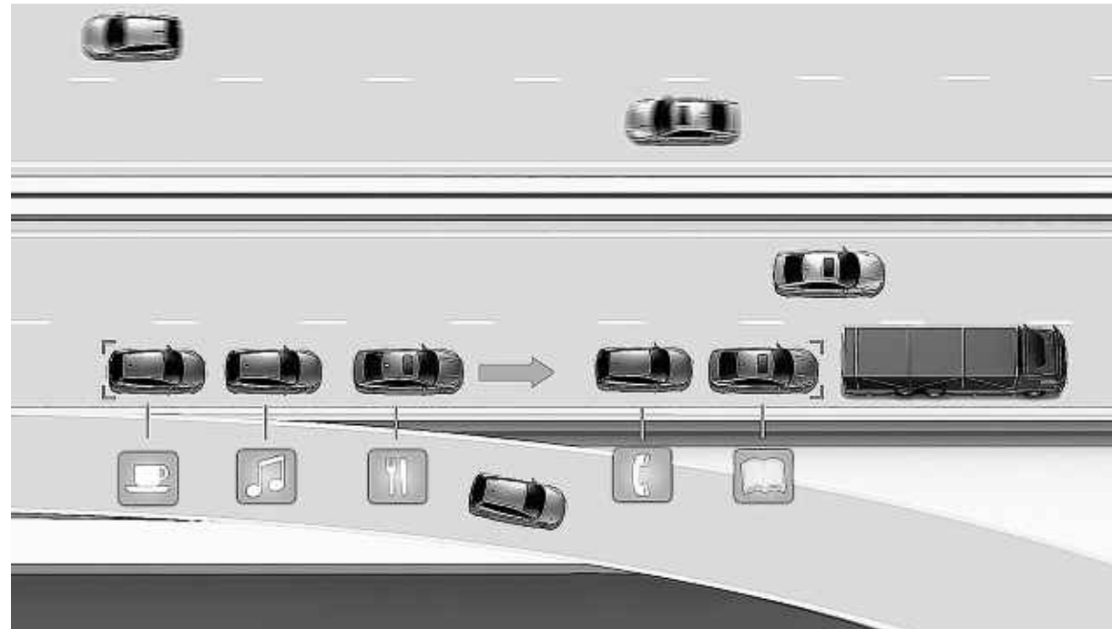
Der Lkw fährt in diesem Beispiel als „Schrittmacher“ voraus: Die Fahrer der nachfolgenden Pkw dürfen entspannen. An der Ausfahrt übernimmt wieder der Mensch und das Auto schert aus. Grafik: Volvo
