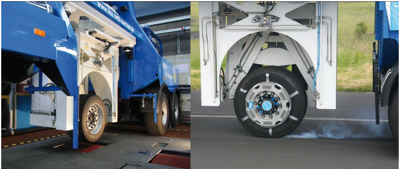
2 Mobiler Reifenprüfstand FaReP auf der Außentrommel im ika-Labor sowie im Messeinsatz auf der Teststrecke des Aldenhoven Testing Centers (ATC) in der Nähe von Aachen
