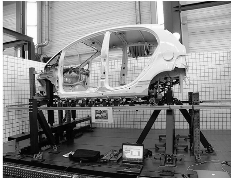
Forschungsobjekt Elektroauto: Hier wird die Karosserie des Modells i-MiEV (Mitsubishi) Teil für Teil analysiert. Foto: Berthold Strauch
