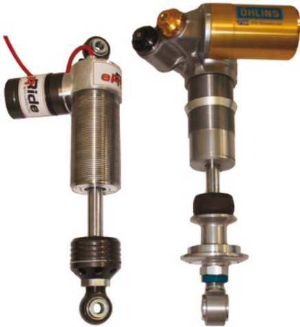
2 Bauraumvergleich zwischen elektro-rheologischem (links) und manuell verstellbarem, passiven Motorradämpfer (rechts)
