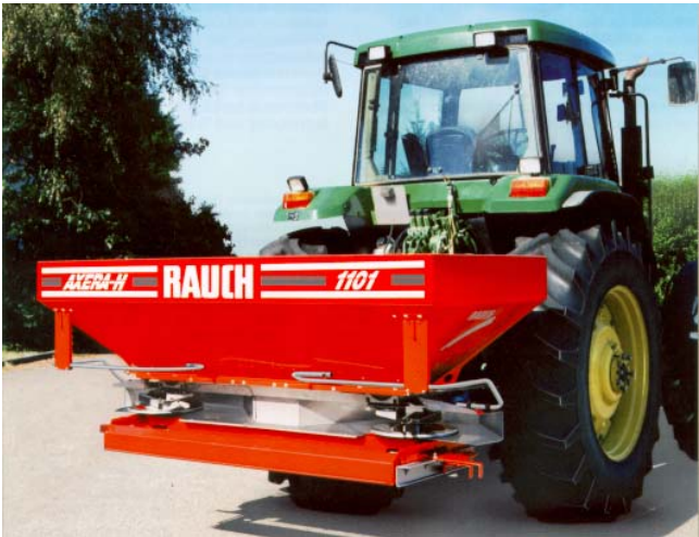
Schleuderstreuer zum Verteilen von granulatartigem Dünger
