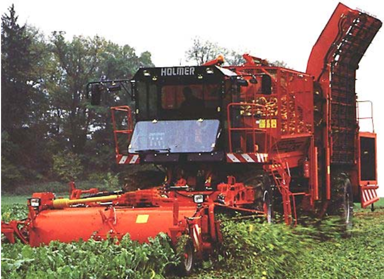
Selbstfahrender 6-reihiger Rübenroder. Das Fahrzeugkonzept ermöglicht das spurversetzte Fahren der Vorder- und Hinterräder
