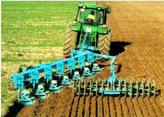
Primärbodenbearbeitung mit Pflug und angehängtem Packer zur Rückverfestigung
