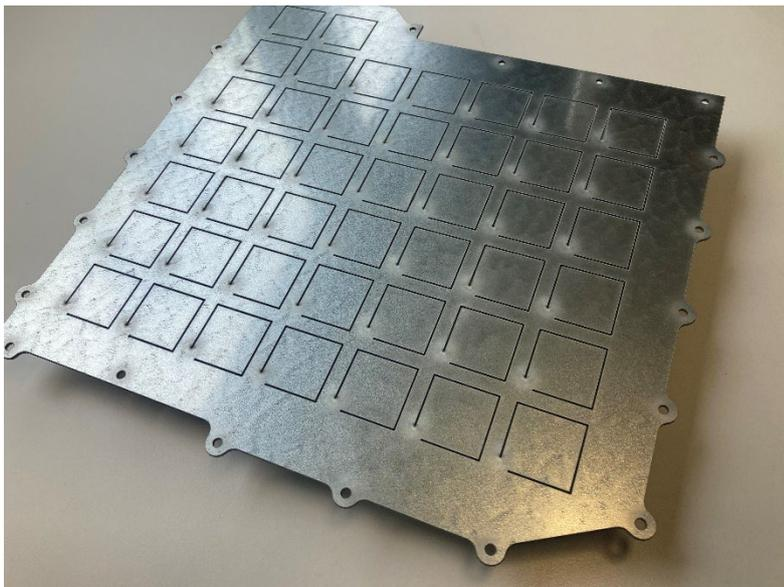
Ein Gehäusedeckel mit integrierter Metamaterialstruktur bietet ein gegenüber konventionellen verbessertes Transmissionsverhalten bei gleichzeitiger Gewichtsreduktion. Foto: Fraunhofer LBF
